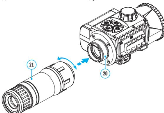
**Примечание:** монокуляр можно устанавливать на тепловизионный модуль с уже установленным адаптером.
