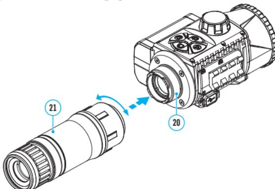
**Nota:** il monocolare può essere installato su un modulo di imaging termico con un adattatore già installato.
