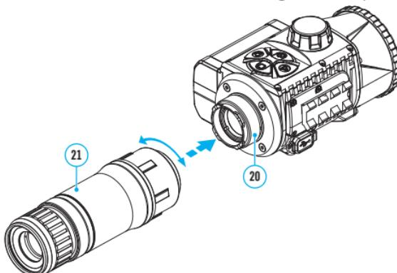
**Remarque:** le monoculaire peut être installé sur un module d'imagerie thermique avec un adaptateur déjà installé.
