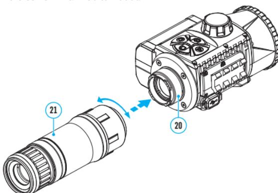
**Hinweis:** Das Monokular kann mit einem bereits installierten Adapter an einem Wärmebildmodul installiert werden.
